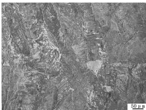
图4 熔核区显微组织
