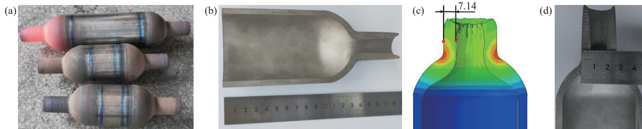
(a)气瓶外观; (b)气瓶剖切; (c)仿真测量结果; (d)试验测量结果
