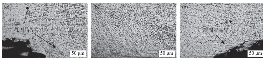
(a)焊缝底部左侧;(b)焊缝底部中心;(c)焊缝底部右侧
