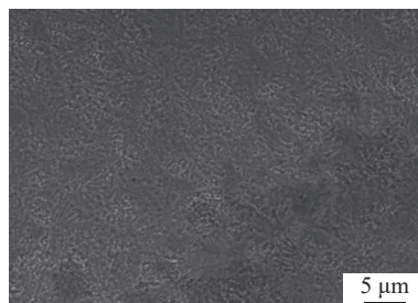
图5 淬火后 SEM 形貌
