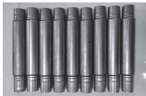
图 4 钛焊管胀管后形貌
