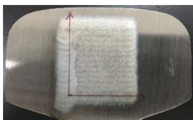
图 8 钢轨轨头金属原位扫描检验区域
