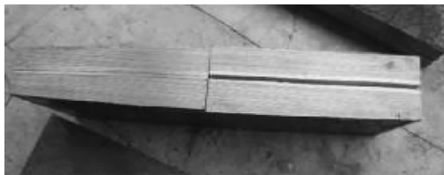
图6 切边后热轧复合产品板复层金属与基层金属结合情况
