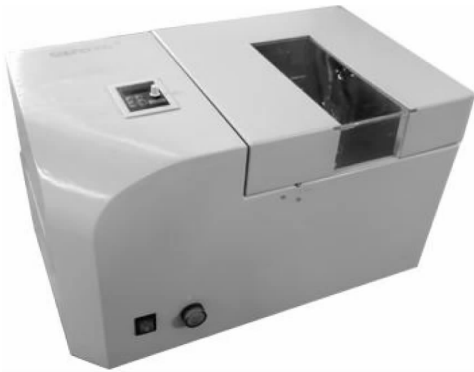
图 1 试验所用的行星式球磨机 Fig.1 Planetary ball mill for test
