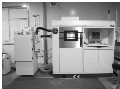
图 2 德国产选区激光熔化设备 EOS M280
